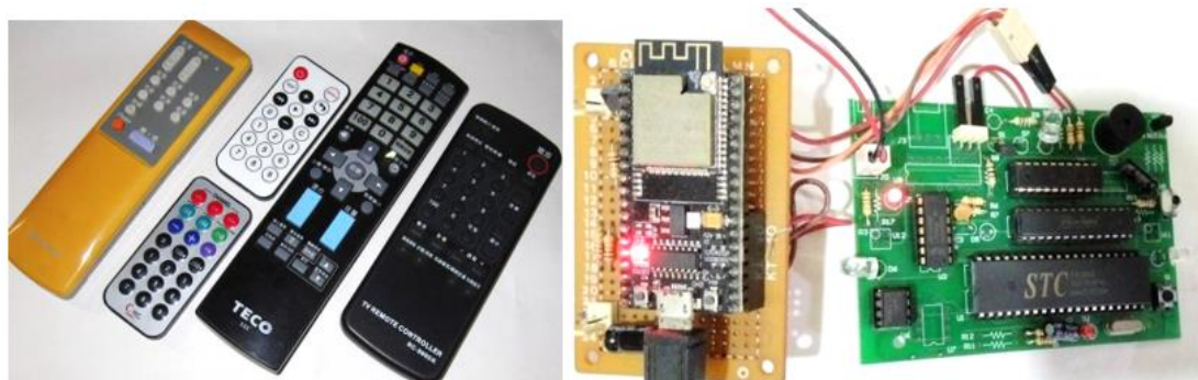
26 ESP32 控制學習型遙控器 L51，可整合多支遙控器，可程式化控制
